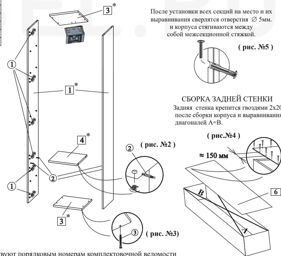
После установки всех секций на место и их выравнивания сверлятся отверстия Ø 5мм. и корпуса стягиваются между собой межсекционной стяжкой.
